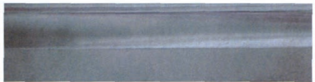
(c) 双道焊,焊缝后退侧相对,间距 2mm
