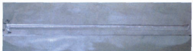
(b) 双道焊,焊缝中心重合
